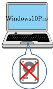
パソコンのUSBに挿して電源ONすれば、PC PLUSからOSが起動
